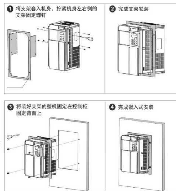
图 3-4 T0.4GB ~ T37G(B), 2T0.4GB ~ 2T18.5G(B) 机型嵌入式安装示意图
