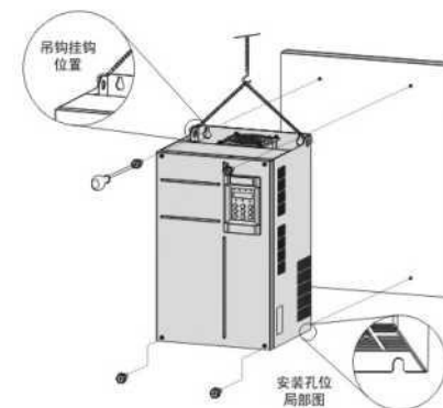
图 3-3 T45G(B) ~ T160G, 2T22G(B) ~ 2T55G 机型壁挂式安装示意图
