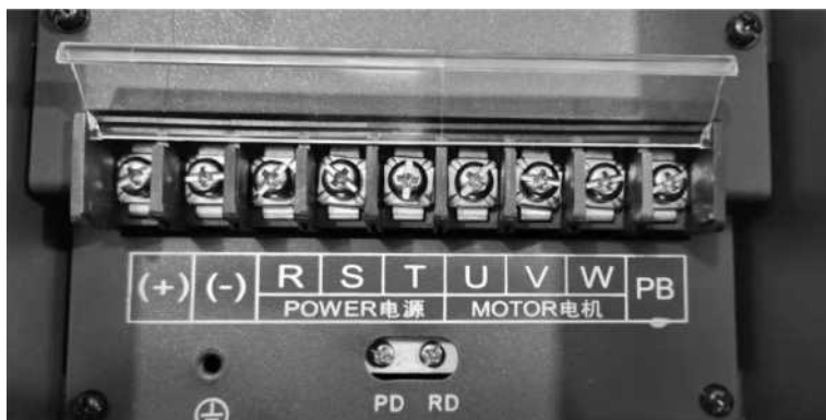
图 3-9 主回路端子分布图
